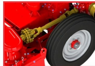
Sistema de transmissão independente na plataforma de corte.
